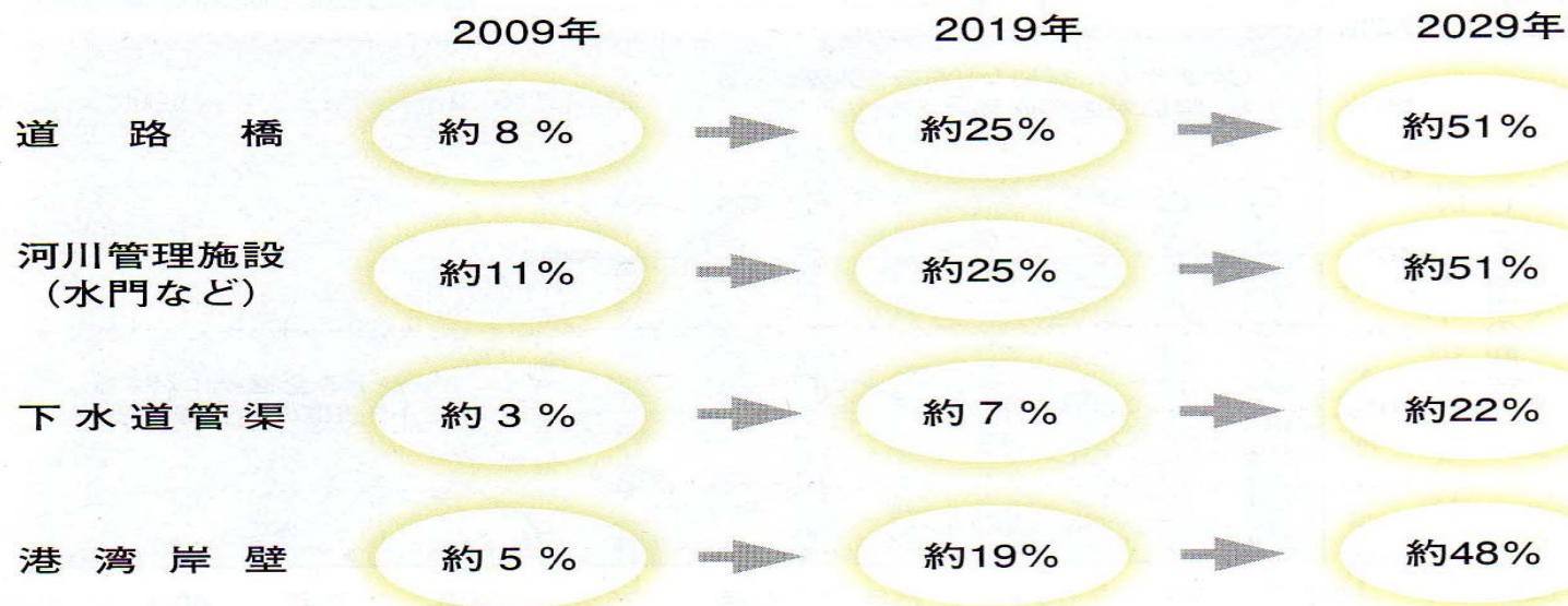
図1 高齢期に入る社会資本 (出典:平成21年度国土交通白書(案)より作成)
